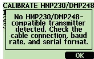
Проверьте чтобы серийные настройки DMP248 и DM70 были одинаковыми. Проверьте кабельное соединение. Затем повторите попытку подключения как указано в пункте 6.
