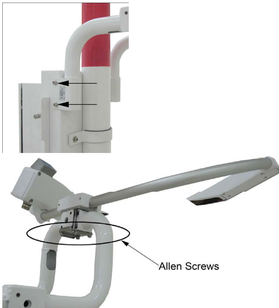
Рис. 11. Закрепление плеча датчика текущей погоды установочными винтами и подключение индикатора осадков PWD32
