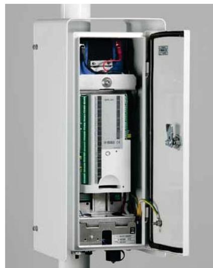
может быть увеличено с 2 до 8 с помощью дополнительных вставных модулей, обеспечивая несколько RS-232, RS-485 и SDI-12 интерфейсов связи. Станция MAWS100 может подключаться непосредственно к локальной вычислительной сети (LAN) посредством коммуникационного модуля Ethernet модуля Ethernet DSE101, предоставляя 10/100Base-T Ethernet. Другие варианты телеметрии включают в себя GSM/GPRS, PSTN, и последовательные соединения.
