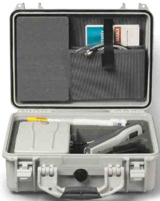
*Работоспособное устройство PTB330TS включает в себя цифровой барометр PTB330, ручной индикатор MI70, дополнительный датчик HMP155 для измерения влажности и температуры, дополнительное ПО MI70 Link для ПК, руководство пользователя и погодоустойчивый футляр для перевозки с наплечным ремнем.*
