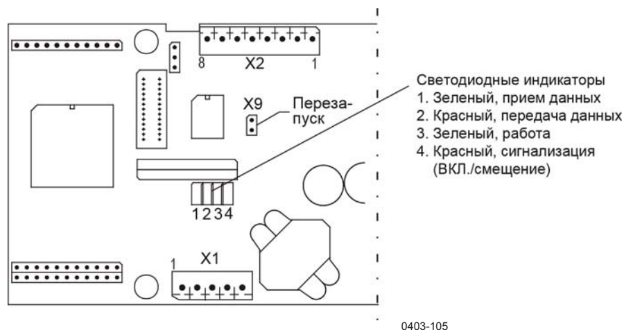
Рис. 7 Светодиодные индикаторы на плате PWC12
