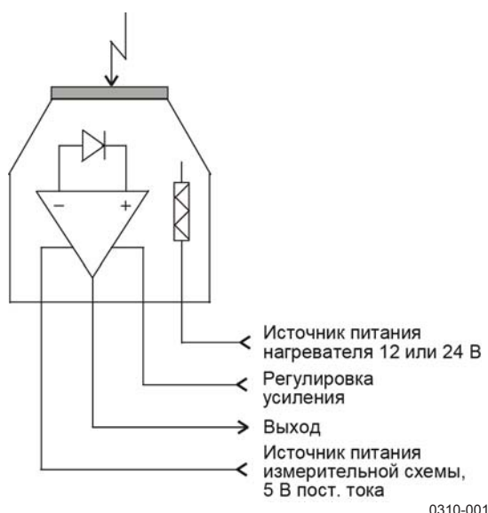
Рис. 5 Блок-схема датчика PWL111
