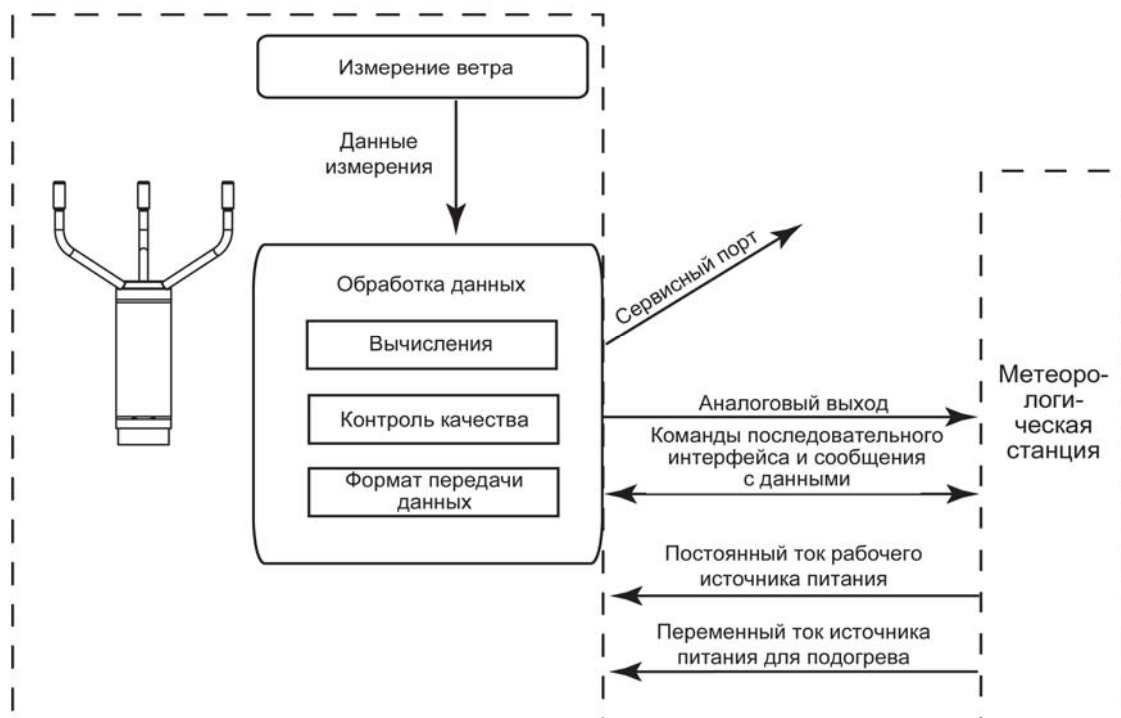
Рис. 10 Внешние интерфейсы датчика ветра WMT700
