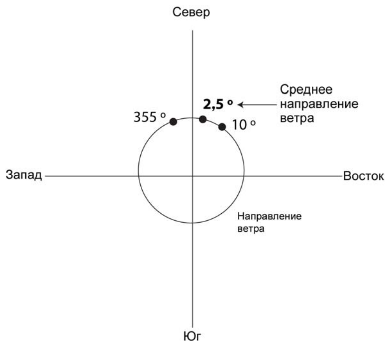
Рис. 9 Пример определения среднего значения направления ветра
